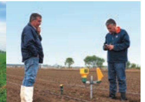
世界各地の畑のセンサーは人工衛星と結ばれ、温度、湿度、降雨などの情報を収集
