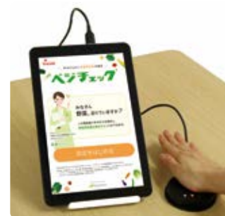
「ベジチェック®」 センサーに手の平を押し当てて約30秒で簡単に推定野菜摂取量を見える化できる機器
