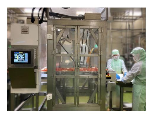
\* 茨城工場に導入した AI を活用したトマトの夾雑物除去システム。AI がトマトの夾雑物を判別し、透明な箱内のロボットが吸引除去する。
