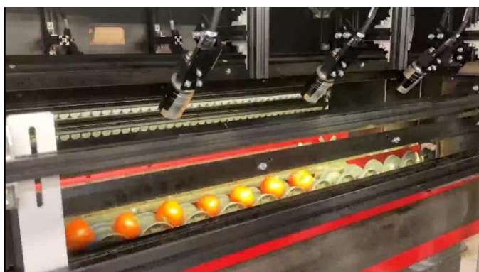
「いわき小名浜菜園」に実装されたAI選果機の様子(左:外観品質カメラ、右:内部品質センサー)
