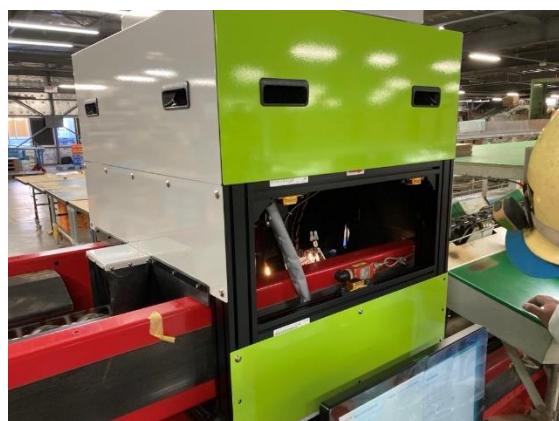
「いわき小名浜菜園」に実装されたAI選果機の様子(左:外観品質カメラ、右:内部品質センサー)
